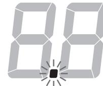
Der Suchlauf stoppt, sobald ein Kanal besetzt ist. Der Suchlauf wird automatisch 3 Sekunden nach dem Ende der letzten Übertragung fortgesetzt, wenn während dieser Zeit keine Taste betätigt wird.
