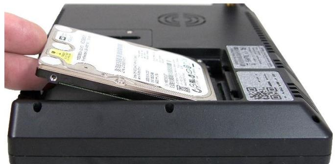
Entfernen Sie die beiden Schrauben von der Abdeckung des Festplattenschachtes und entfernen Sie die Abdeckung. Platzieren Sie die Festplatte schräg (Anschlüsse nach vorn gerichtet) vor dem Festplattensteckplatz.
